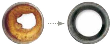
**2) calmat® sana cuidadosamente todo el sistema de tuberías.** En el proceso natural de cristalización se deposita la cal, que es disuelta a su misma vez por el ácido carbónico. **calmat®** altera este equilibrio, de forma que las incrustaciones existentes se disuelven debido a un superávit de ácido carbónico.
