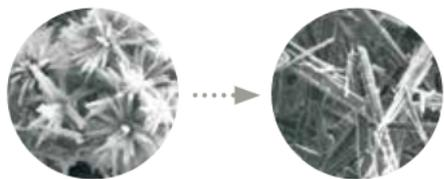
**1) calmat® disminuye incrustaciones de cal en tuberías y aparatos.** Conduce al agua impulsos eléctricos con alta frecuencia que modifican la cristalización de la cal. Tras el tratamiento, como resultado, se disminuye la adhesión y la acumulación de cal en la tubería.
