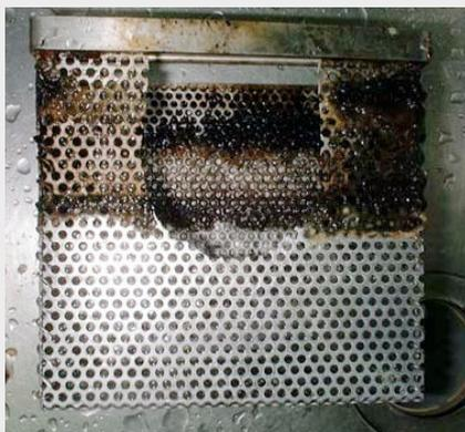
La canasta después del lavado con una manguera. Las partes que normalmente están en contacto con el agua tratada se limpian fácilmente con un chorro de agua del grifo.
