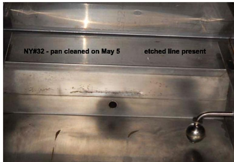
Después de la instalación de Vulcan: el área de la bandeja ahora está totalmente libre de cal. Se observa una leve hendidura en la línea de flotación de la bandeja.
