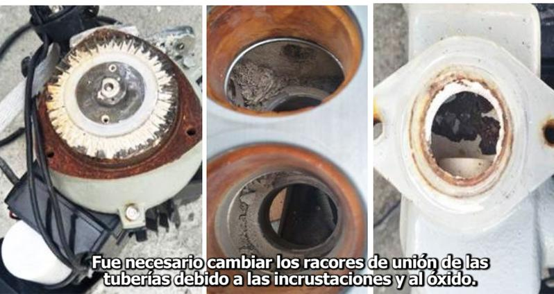
Fue necesario cambiar los racores de unión de las tuberías debido a las incrustaciones y al óxido.
