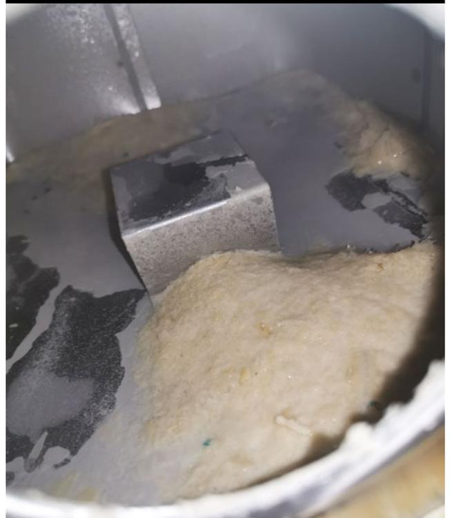
La cal se transformó completamente en polvo, por lo que no es necesario abrir la vaporera para limpiarla. Mediante la función normal de desagüe se puede mantener el depósito de agua caliente limpio y sin cal. Gracias a los buenos resultados obtenidos, realizaremos otra colaboración con Vulcan para los sistemas de suministro de agua y de aire acondicionado central del hotel.
