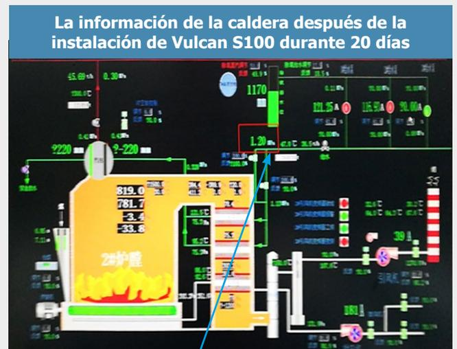
Cuando la presión de operación se tiene que mantener constante sin Vulcan, la presión en la tubería principal de agua aumenta con el tiempo: debido a que las incrustaciones aumentan, la presión también aumenta.
