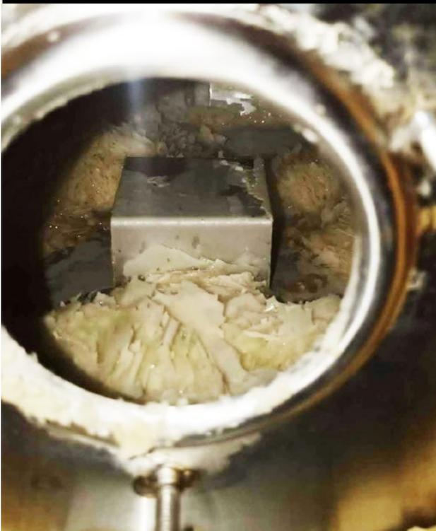
Habían escamas de cal que no pasaban por el agujero de desagüe de la vaporera. Para probar la eficacia del equipo Vulcan S10, no se procedió a ninguna limpieza antes de instalarlo.
