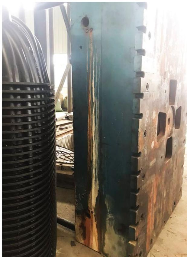
La imagen de arriba es el molde de la fosa séptica sin tratamiento con Vulcan. Después de un mes de funcionamiento, la cal se había incrustado, e incluso los pequeños orificios de agua estaban bloqueados. Debido a que era muy difícil de limpiar, se necesitaba devolver al fabricante para su limpieza, lo que afectó enormemente la capacidad de producción.
